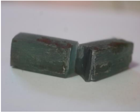
Gambar 3. Pola patahan benda uji impact komposit dengan komposisi 0%:100%
