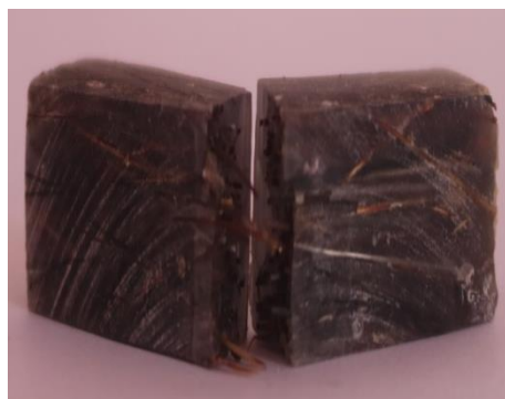
Gambar 5. Pola patahan benda uji impact komposit dengan komposisi 20%:80%
