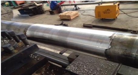
Gambar 1 Proses Pengelasan dan Pembubutan Poros Baling - Baling
