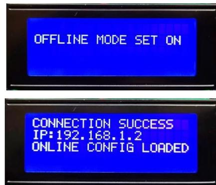
Gambar 12. Kondisi koneksitas NodeMCU
