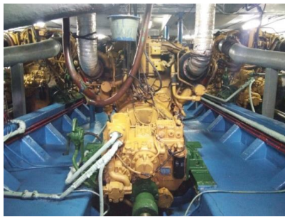
Gambar 2. Mesin induk kapal Express Cantika 88
