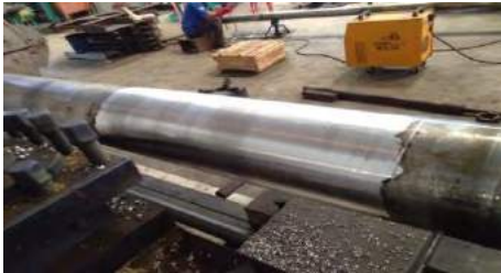
Gambar 1 Proses Pengelasan dan Pembubutan Poros Baling - Baling
