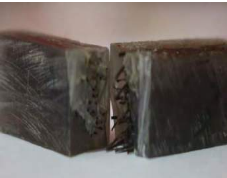
Gambar 4. Pola patahan benda uji impact komposit dengan komposisi 10%:90%
