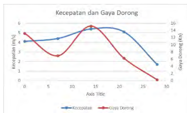
Gambar 1. Kecepatan dan Gaya Dorong (Mesin di luar Lambung Perahu)
