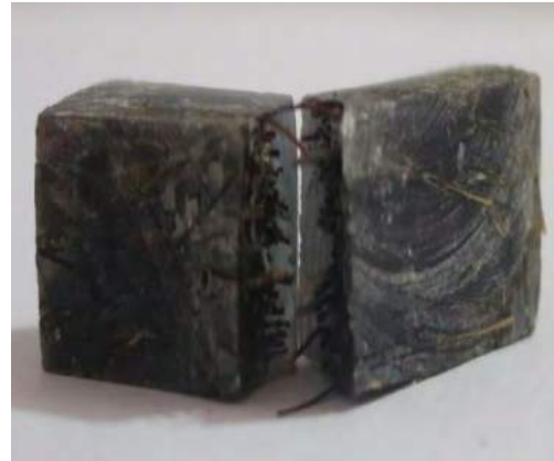
Gambar 6. Pola patahan benda uji impact komposit dengan komposisi 30%:70%
