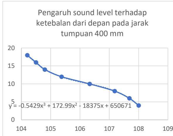
Grafik 1. Hubungan sound level terhadap ketebalan dari depan untuk jarak pengukuran 50 mm untuk tumpuan 400 mm pada bidang depan (coating)
