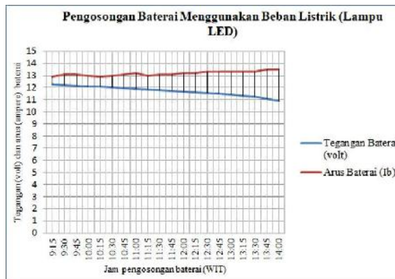
Gambar 14. Grafik pengosongan baterai menggunakan beban listrik (lampu LED)
