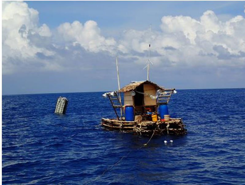
Gambar 2. Jenis rakit/gubuk tempat tinggal penjaga rumpon dan pelampung yang terbuat dari styrofoam (gabus) (Satrioajie, dokumentasi pribadi)
