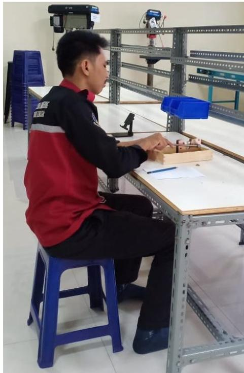
**Gambar 5.** Usulan postur kerja dengan menggunakan alat pemecah biji kenari
