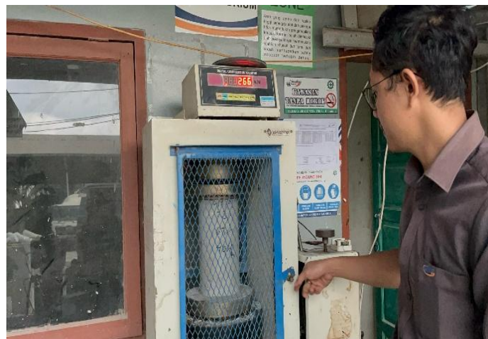
Gambar 4. Proses pengujian beton High Early Strength bersama peserta.
