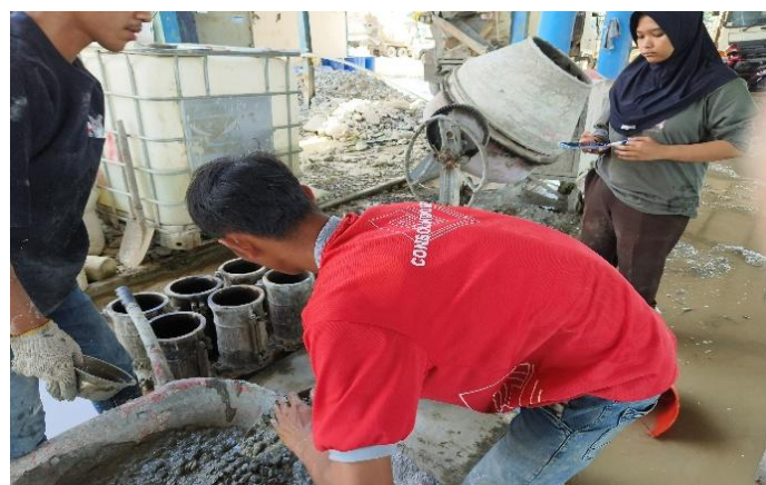
Gambar 3. Proses pencampuran dan simulasi pembuatan beton High Early Strength bersama peserta.
