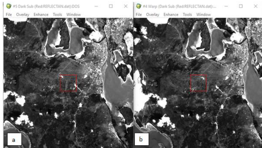
Gambar 4. Citra Landsat 8 (OLI) Pulau Kei Kecil 2019 saluran 4: a) sebelum koreksi geometrik ; b) sesudah koreksi geometrik.
