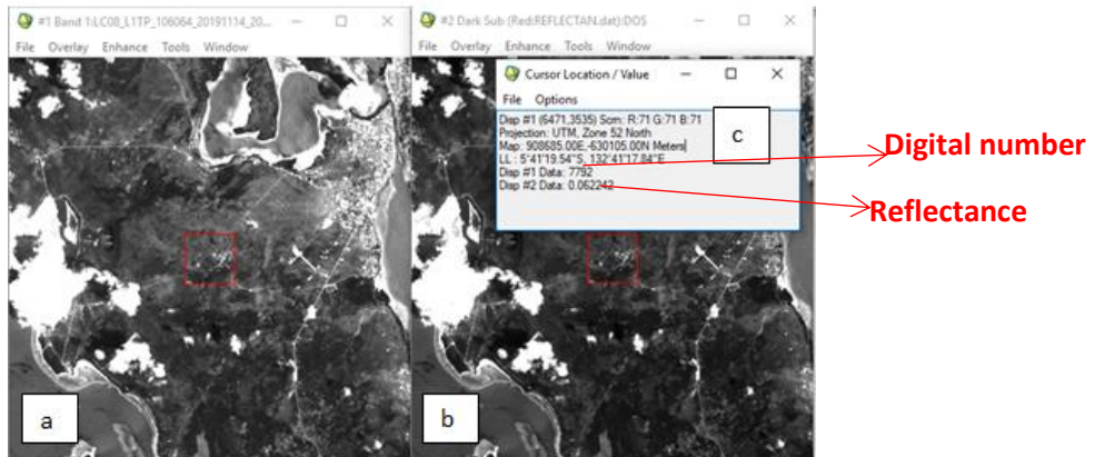
Gambar 2. Digital number dan hasil koreksi radiometrik Saluran 4; a) digital number; b) reflectan; c) nilai digital number dan nilai reflektan.
