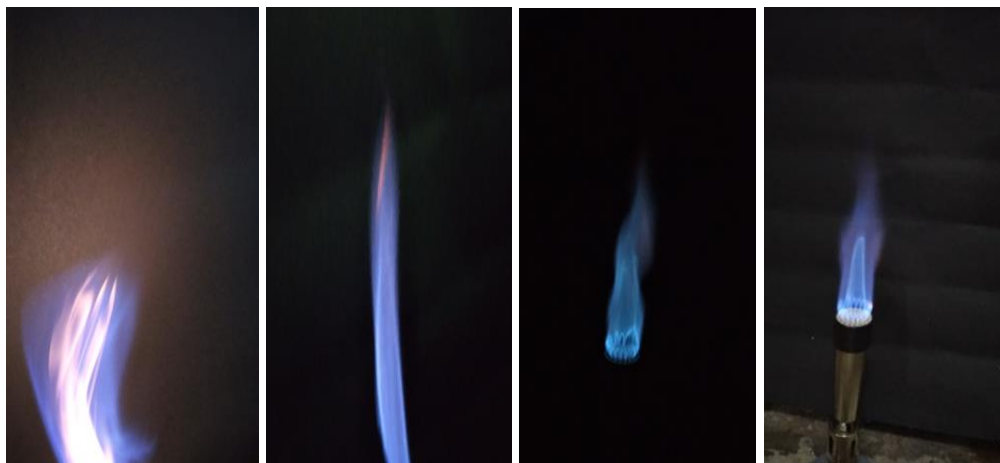
Gambar 2. Uji pembakaran biogas
