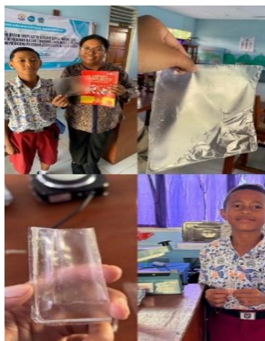
Gambar 4. Hasil pembuatan bioplastik berbasis pati singkong dan contoh pemanfaatannya sebagai kemasan sederhana
