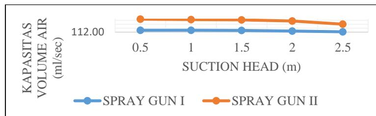
Gambar 2. Pengaruh Suction Head Terhadap Kapasitas Volume Air untuk Spray Gun Pertama dan Spray Gun Kedua
