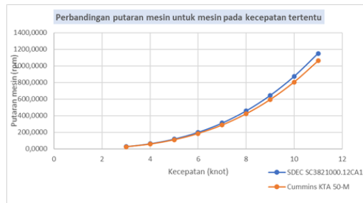
Gambar 4 Grafik perbandingan putaran yang dibutuhkan untuk mencapai kecepatan tertentu menggunakan motor induk lama dan baru
