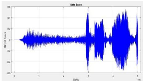
Pada gambar 3.4 memperlihatkan hasil rekaman suara telepon VoIP dengan durasi 5 menit amplitudo maksimum di atas level 0,4 V. Terlihat pada gambar 3.4 data time domain suara dengan durasi waktu 5 detik dengan sinyal suara mencapai 0,6 V.
