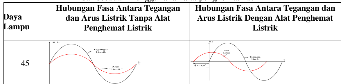
Gambar 5 Grafik hubungan fasa antara tegangan dan arus 3 buah lampu LED 15 W sebelum dan sesudah menggunakan alat penghemat listrik
