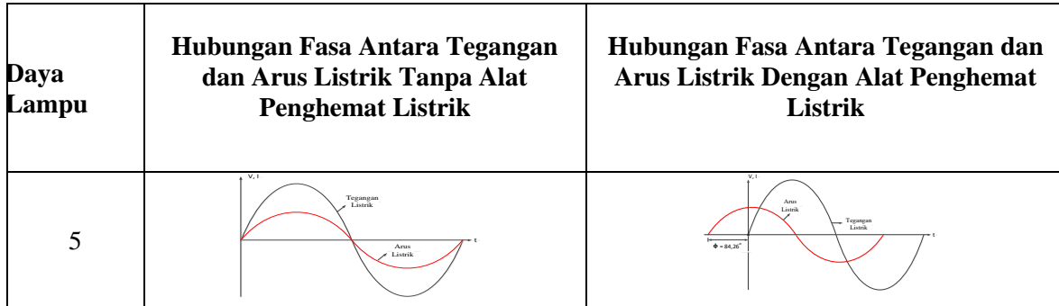
Gambar 3 Grafik hubungan fasa antara tegangan dan arus 1 buah lampu LED 15 W sebelum dan sesudah menggunakan alat penghemat listrik
