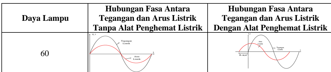
Gambar 9 Grafik hubungan fasa antara tegangan dan arus 2 buah lampu LED 30 W sebelum dan sesudah menggunakan alat penghemat listrik
