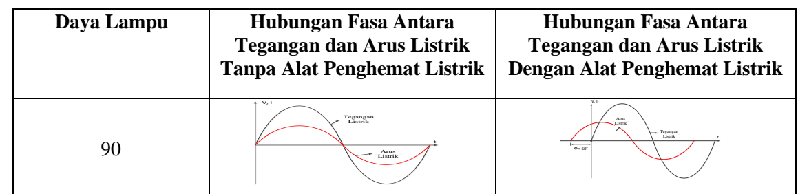
Gambar 10 Grafik hubungan fasa antara tegangan dan arus 3 buah lampu LED 30 W sebelum dan sesudah menggunakan alat penghemat listrik
