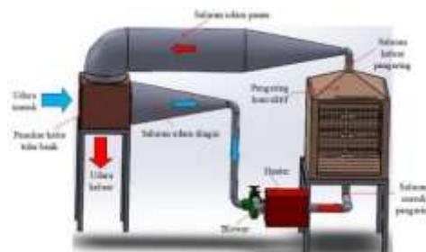
Gambar 1. Skema pengering konvektif limbah panas.
