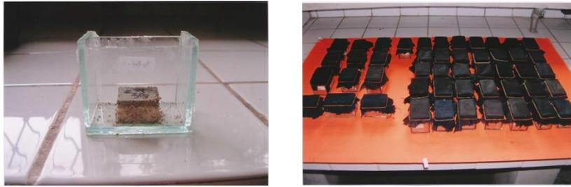
**Gambar 1.** Kotak dan contoh uji untuk pengujian ketahanan papan terhadap serangan rayap kayu kering di laboratorium
