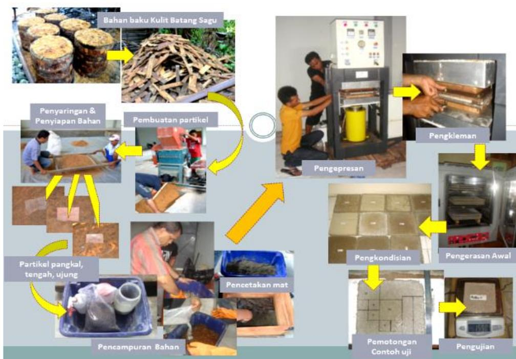
Gambar 1. Proses Pembuatan Papan Semen dari Limbah Kulit Batang Sagu
