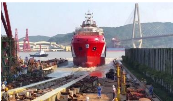
Gambar 1.1 Slipway menggunakan Rel.
