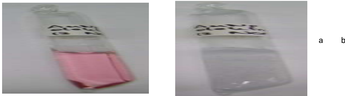
Gambar 5. Emas nanopartikel hasil sintesis dengan metode elektrokimia ( \text{AuNp I} ), (a) pada suhu ruang, (b) pada suhu 1^\circ\text{C} .
