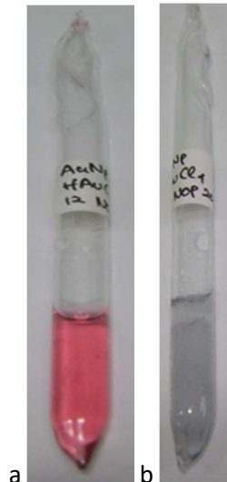
Gambar 6. Emas nanopartikel hasil sintesis dengan metode Turkevich (AuNpII), (a) pada suhu ruang, (b) pada suhu -2^{\circ}\text{C} .
