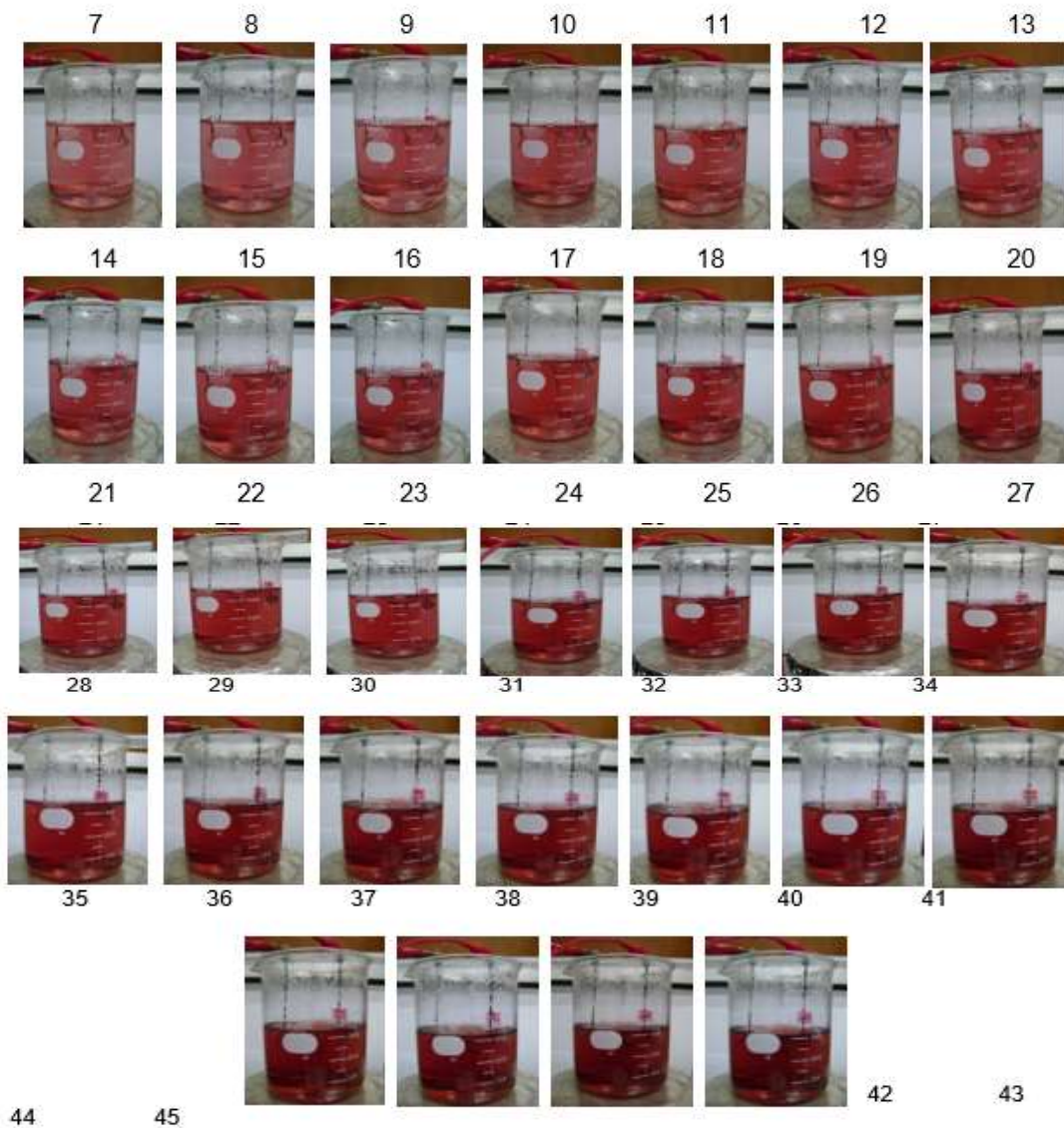
Gambar 3. Proses elektrolisis sintesis emas nanopartikel dari natrium sitrat 0,3 M dan NaCl 0,02 M selama 4 menit.
