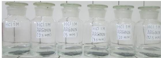
**Gambar 2.** Proses uji inhibisi korosi baja SS-304 dalam media HCl dengan variasi konsentrasi arginin
