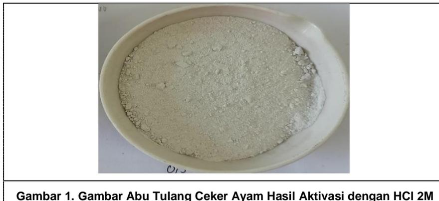
**Gambar 1** menunjukkan bahwa abu tulang ceker ayam yang telah mengalami proses aktivasi berwarna putih dan lebih bersih karena telah terjadi pelarutan pengotor berupa tar berwarna hitam maupun pengotor-pengotor lainnya. Hilangnya zat pengotor mengakibatkan luas permukaannya semakin besar dan daya adsorpsinya semakin meningkat (Sianipar dkk., 2016).
