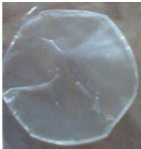
**Gambar 1. Membran PEC kitosan pektin PEGDE**
