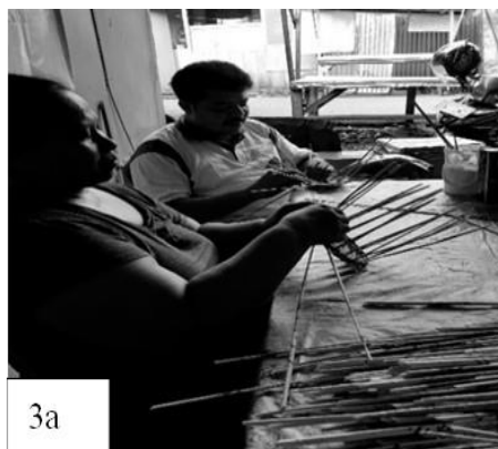
Gambar 3a dan 3b. Pembuatan lilitan koran ukuran panjang
