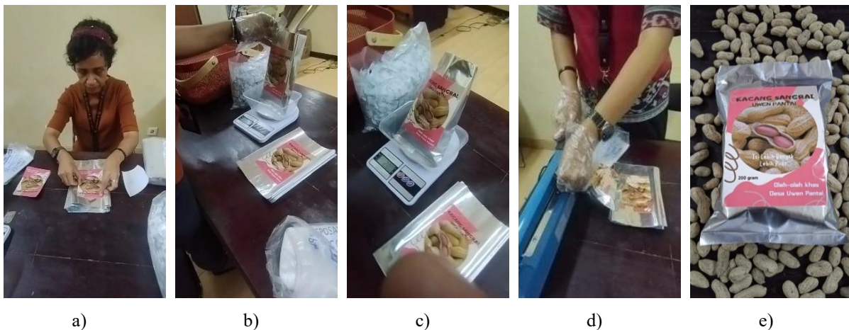
Gambar 4. Alur pengemasan produk kacang sangrai a) penempelan label kemasan, b) memasukkan produk ke dalam kemasan, c) penimbangan produk, d) merekatkan kemasan, e) tampilan produk kemasan kacang sangrai
