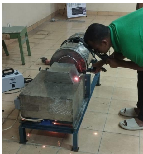
Gambar 2. Proses pembuatan dan modifikasi mesin sangrai
