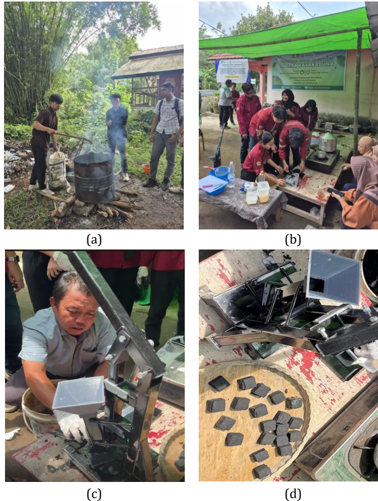
Gambar 2. Kegiatan pelatihan dan praktik pembuatan briket dari baglog jamur (a) Pembuatan arang, (b) Pencampuran bahan, (c) Pencetakan briket, (d) Briket baglog jamur
