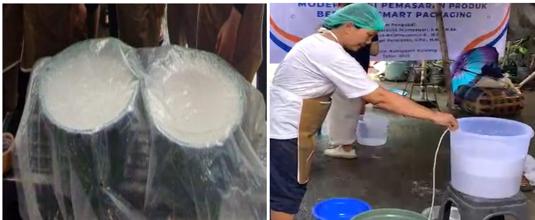
Gambar 3. Proses penyaringan, pendiaman dan pemisahan krim
