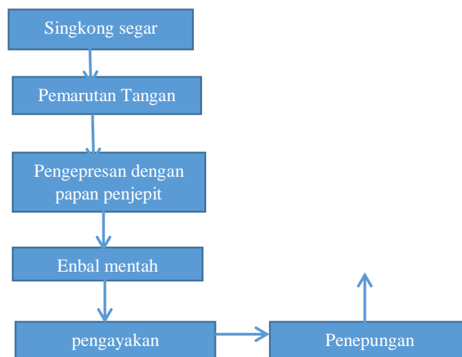
Gambar 1. Diagram alir pembuatan tepung enbal cara tradisional (Riry et al, 2013).
