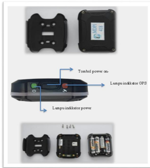
Gambar 2. Peralatan Spot Trace yang digunakan nelayan pancing tuna
