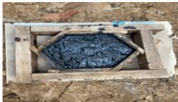
Gambar 2. Proses memasukkan adonan eco-paving block ke dalam cetakan
