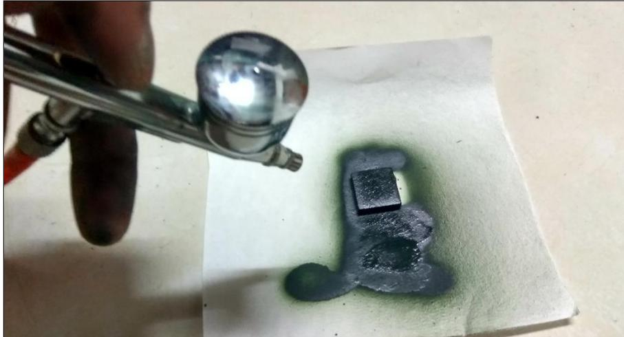
**Gambar 2.** Tampilan hasil *coating* menggunakan metode *spraying*
